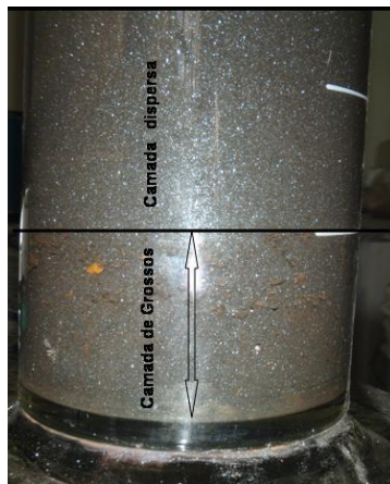
Figura 5.8: Amostra AdoB352 20%SF, C_w = 72,2\% , Mostrando a Formação de uma Camada de Material Grosso no Fundo da Proveta após Sedimentação
