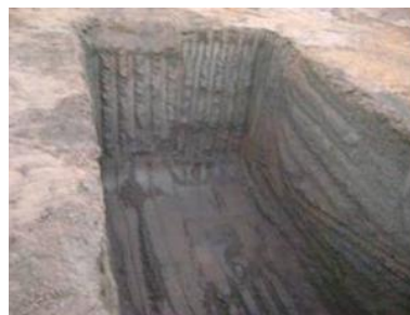
Figura 6.31: O material bem compactado (Cruz, 2009).
