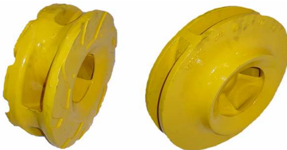
Figura 3.18: Rotores standard (esquerda) e de alta eficiência (direita) (LEITE, 2009).
