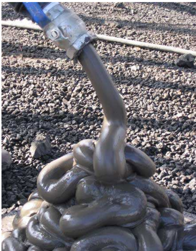
FIGURA 3.8: Aspecto da pasta oriunda de espessadores de alta densidade (WESTECH, 2008).
