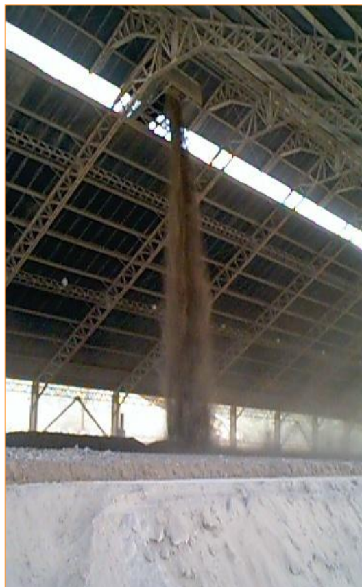
Figura 3.3: Stacker realizando a homogeneização da pilha de argical. (ECL, 2009)
