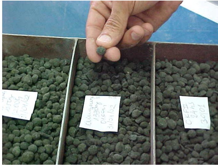
Figura 3.14: Clinker para análise do laboratório (ECL, 2011)
