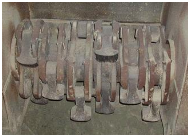
Figura 3.4: Martelo do Britador Primário (ECL, 2009)
