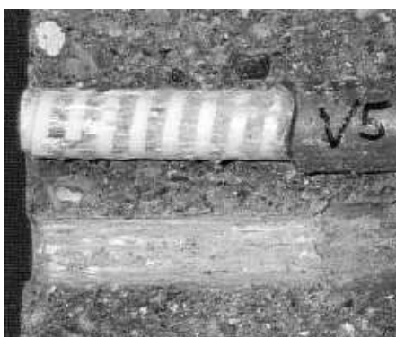
Figura 11 – Teste de arrancamento em barra de FRP (Witt, 2009)
