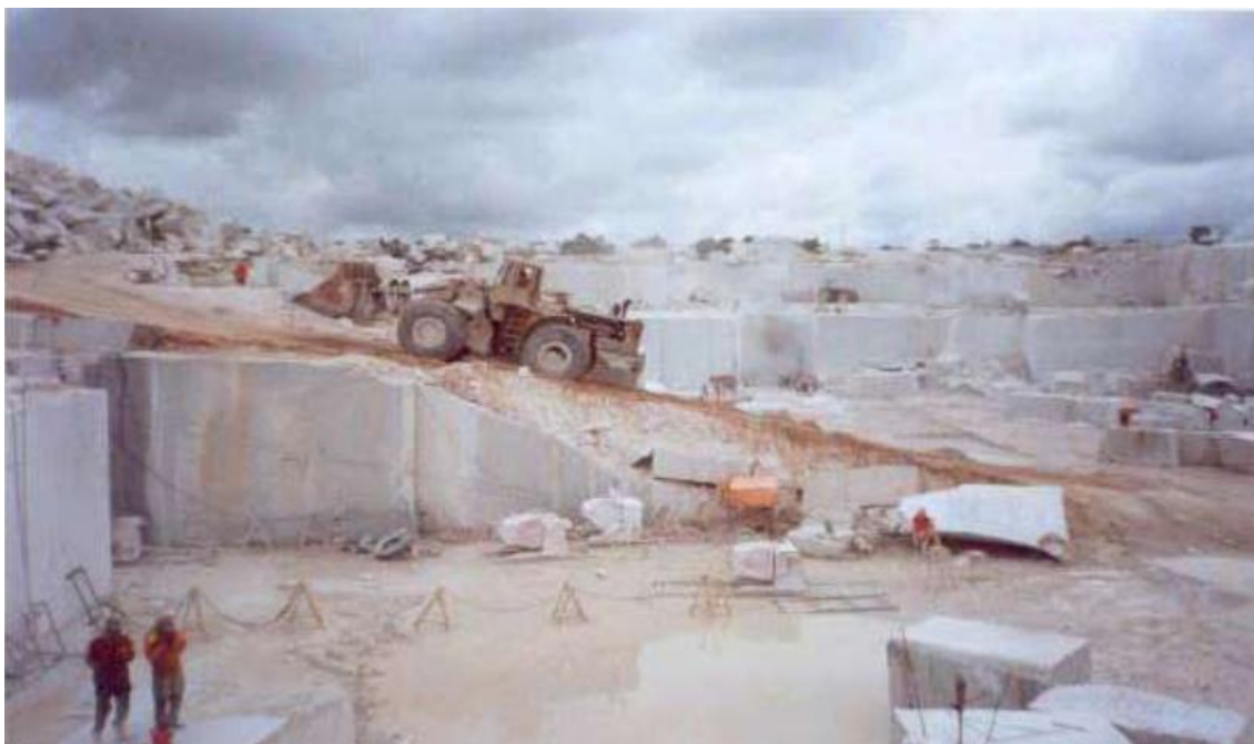
Figura 3.8 – Exemplo de lavra tipo fossa Fonte: Pinheiro, 2003 apud Menezes, 2005
