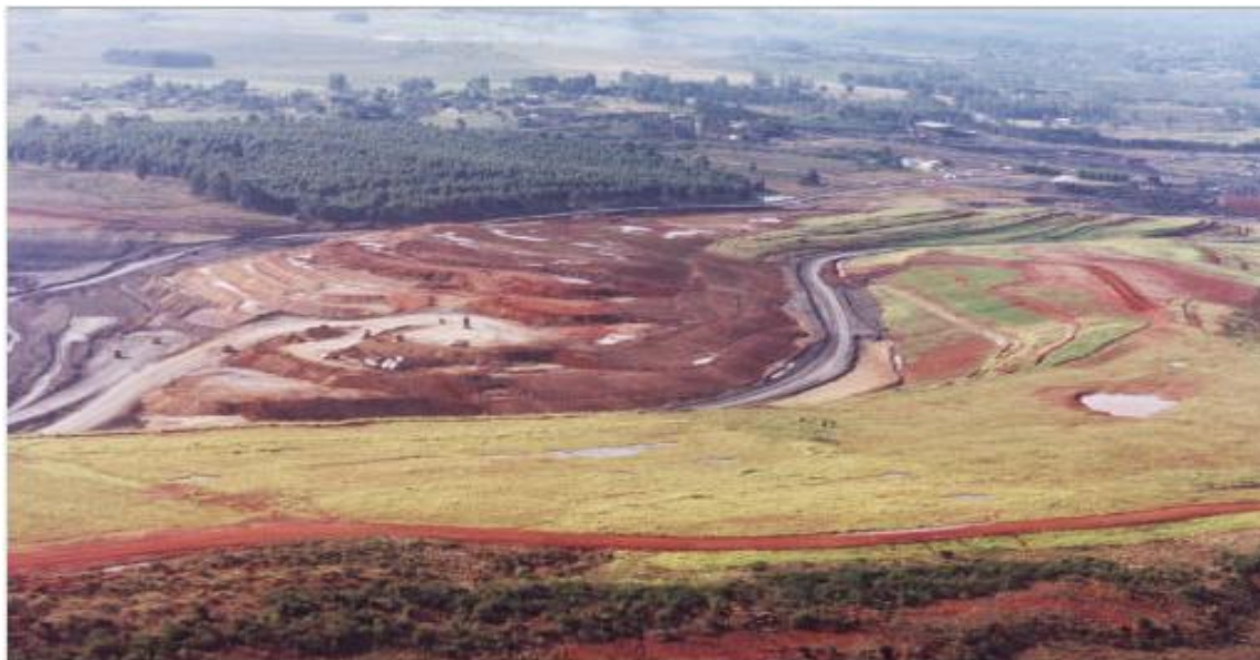
Figura 3.17 - Desenvolvimento da lavra de carvão (esquerdacentro) na Mina do Recreio, Rio Grande do Sul, processo de recuperação em andamento (direita e plano inferior) e área reflorestada (topo-esquerda)
