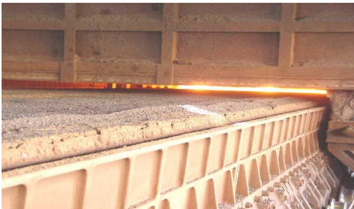
Figura 3.7 - Detalhe da ignição na máquina de sinterização (Curso de Mineração Básico – Vale, 2009)
