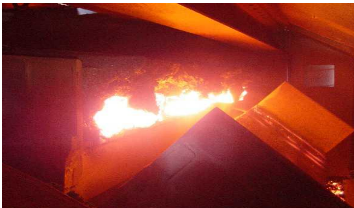
Figura 3.9 - Frente de combustão (queima) na máquina de sinterização (Curso de Mineração Básico – Vale, 2009)
