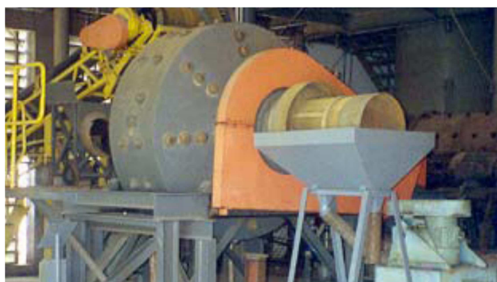
Figura 3.29. Moinho autógeno – Unidade Piloto do CETEM (Figueira, 2004).
