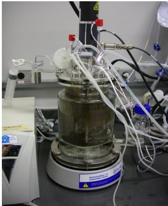
FIGURA 4.2 – RBS utilizado para o enriquecimento e cultivo de bactérias anammox
