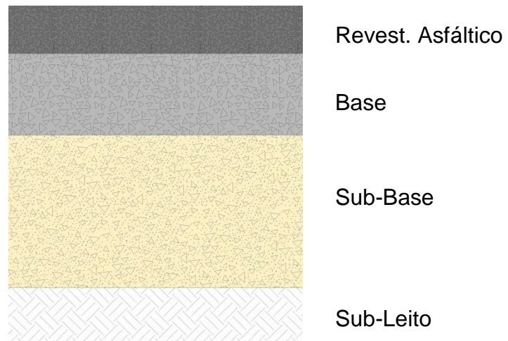
Figura III.2 – Pavimento com base granular
