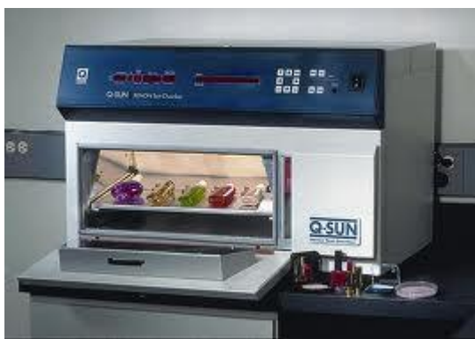
Figura III.5 – Câmara de Intemperismo- marca Q-Sun XE-1
