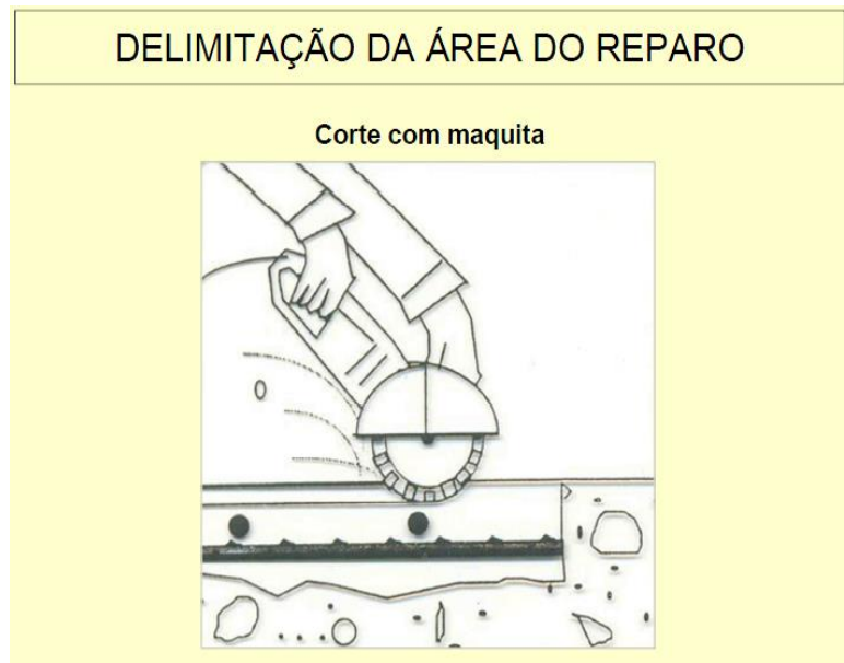
Figura 13 – Aguiar J. – Apostila Mecanismo de Deterioração do Concreto - Delimitação da área do reparo.
