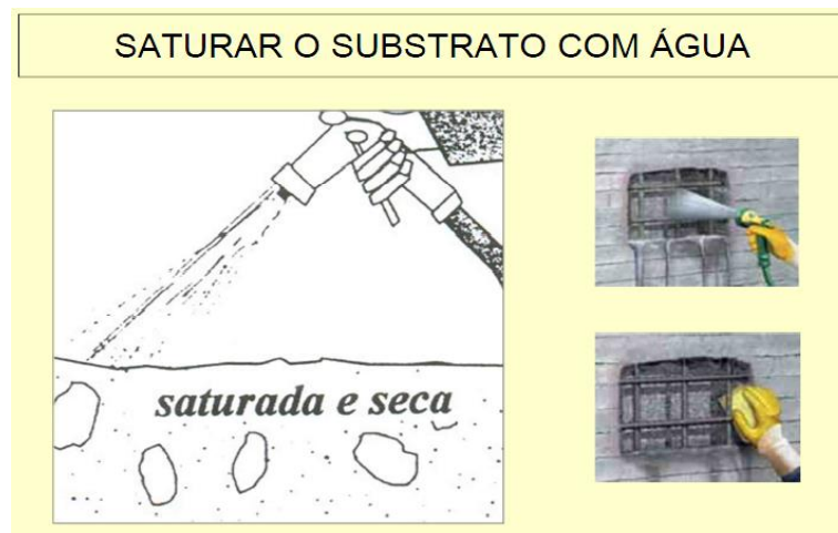
Figura 21 – Aguiar J. – Apostila Mecanismo de Deterioração do Concreto - Saturar o substrato com água.
