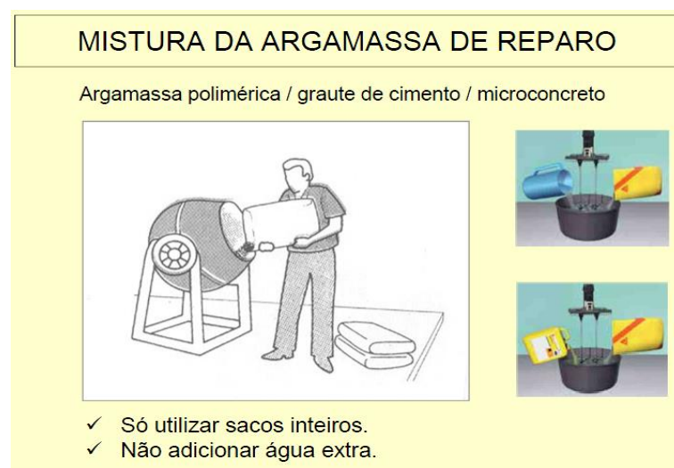
Figura 22 – Aguiar J. – Apostila Mecanismo de Deterioração do Concreto - Mistura da argamassa de reparo.
