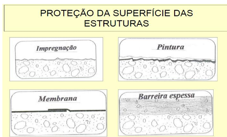
Figura 28 – Aguiar J. – Apostila Mecanismo de Deterioração do Concreto - Proteção da superfície das estruturas.
