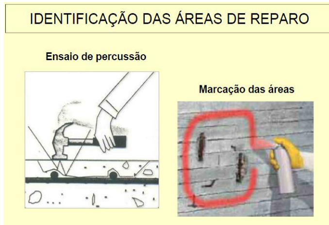
Figura 11 – Aguiar J. – Apostila Mecanismo de Deterioração do Concreto - Identificação das áreas de reparo.
