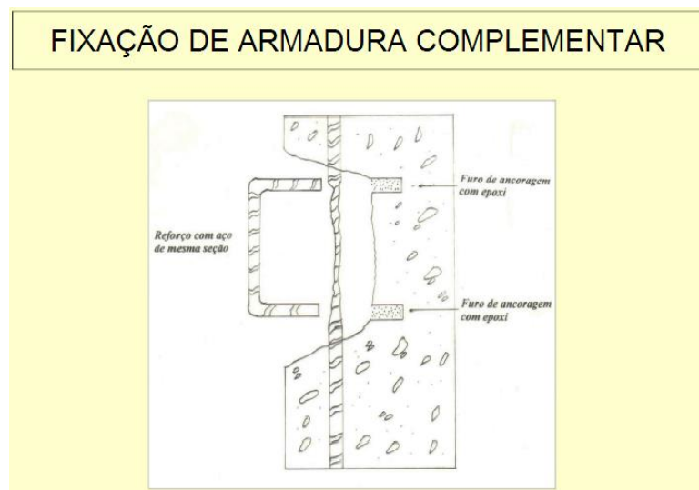
Figura 18 – Aguiar J. – Apostila Mecanismo de Deterioração do Concreto - Fixação de armadura complementar.
