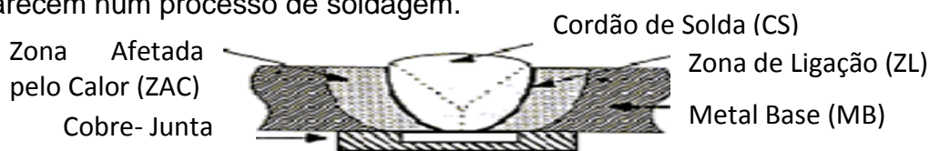
FIGURA I: Junta soldada, mostrando o cordão de solda (CS), a zona de ligação (ZL) e a zona afetada pelo calor (ZAC).
