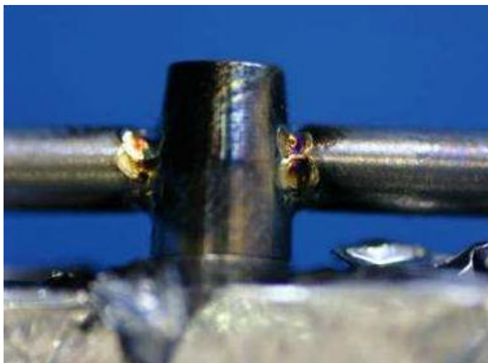
Figura III - b) Aspecto das barras soldadas aos pilares de titânio.
