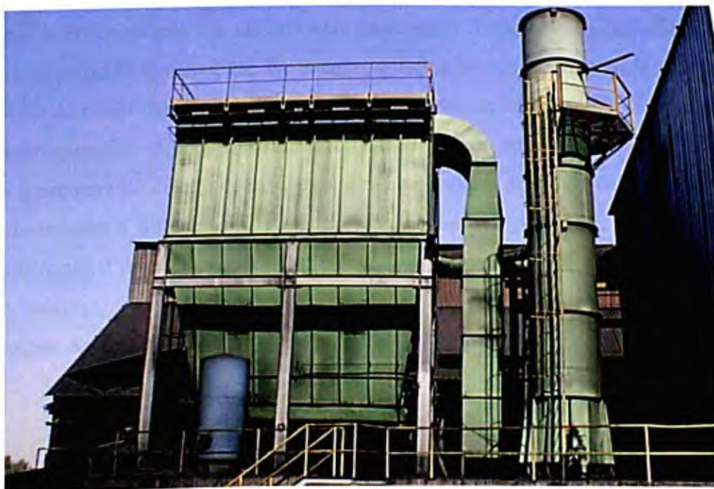
**Figura 3.26** - Equipamento de controle, filtro de mangas
