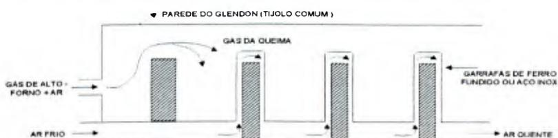
Figura 3.15 - Corte longitudinal de uma parte do Glendon
