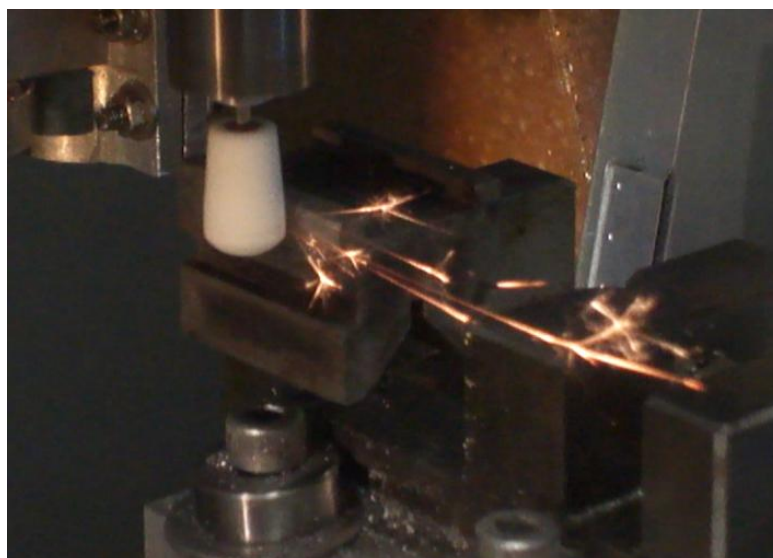
Figura 99 - Operação de retífica com corte tangencial
