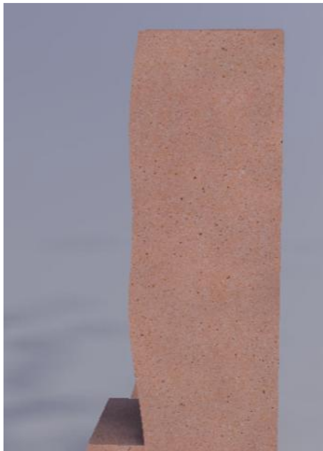
Figura 37 - Deformação na superfície de assentamento do eixo Y
