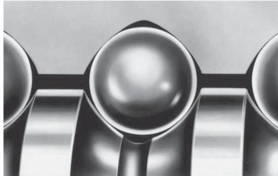
Figura 10 - Princípio do fuso de esferas: O atrito de deslizamento é substituído pelo de rolamento pela inserção de esferas entre a porca e o fuso
