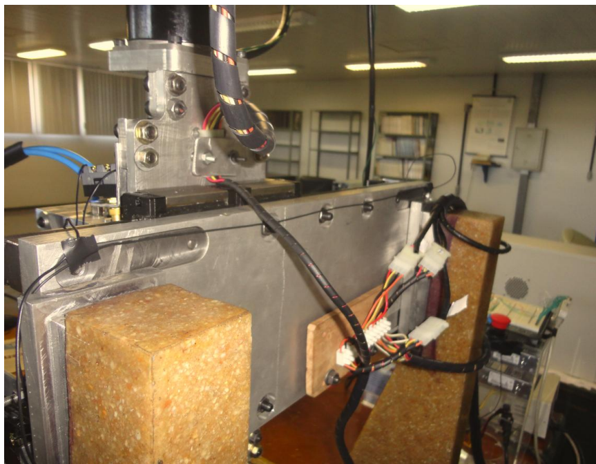
Figura 63 – Painel para conexão dos motores
