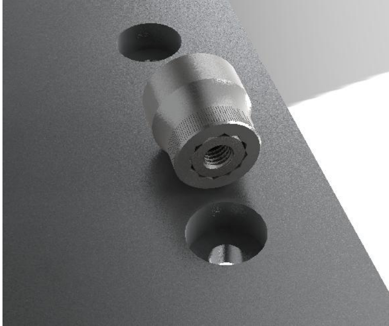
Figura 30 - Deficiência do projeto: A ferramenta não cabe no furo
