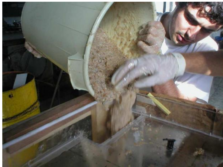
Figura 35 – Vazamento do concreto polimérico no molde de acrílico Fonte: SHOJI, 2002
