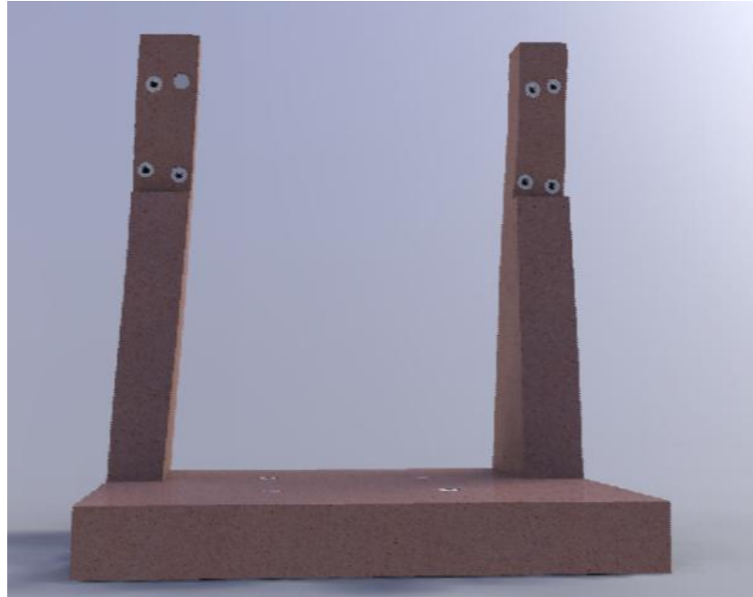
Figura 36 - Deformação na coluna da estrutura
