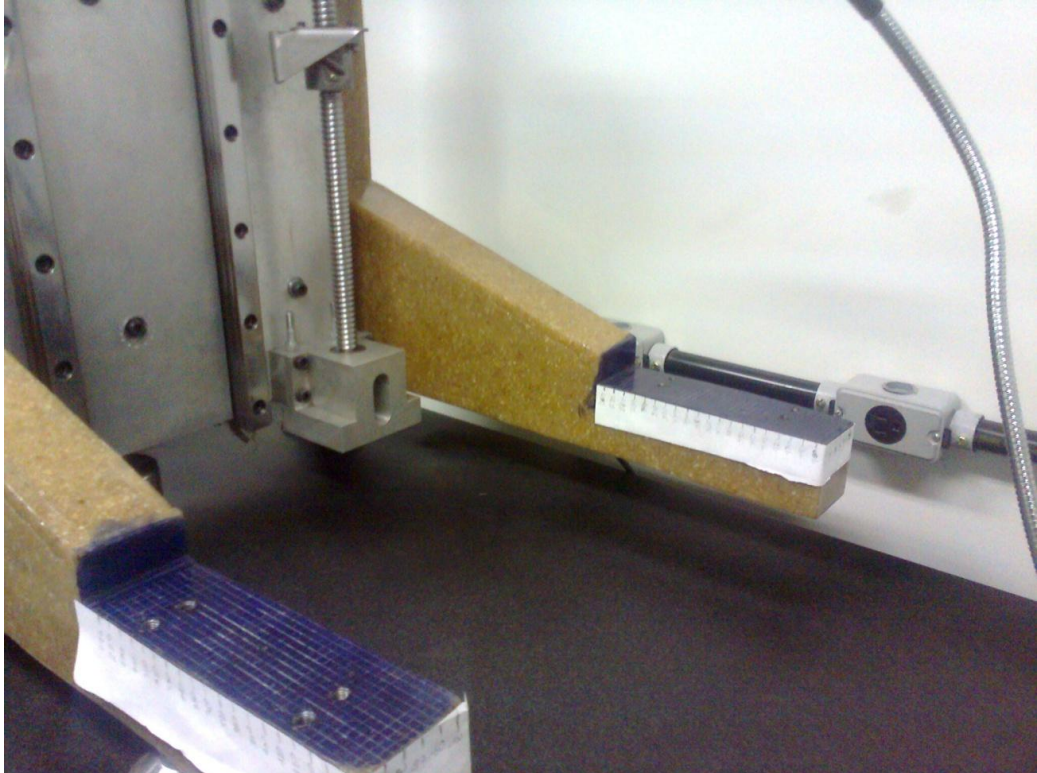
Figura 42 - Superfícies de assentamento do eixo Y, já traçadas
