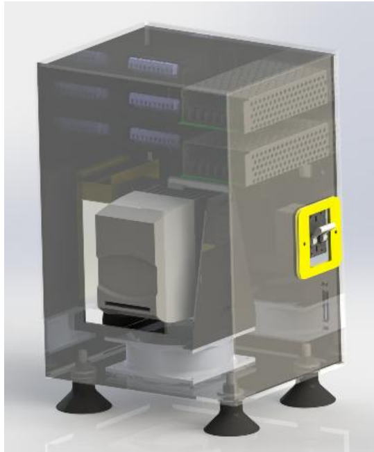
Figura 62 – Acesso aos botões do inversor de frequência mesmo com a porta fechada
