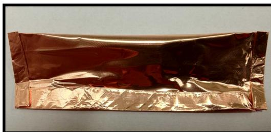
Figura 10.1: Envelope de cobre contendo as folhas de cobre em seu interior que funcionarão como substratos para crescimento do grafeno CVD.
