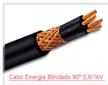
Figura 20. Cabo de controle 0,6/1kV blindado por malha de fios de cobre trançado (Adaptado de [8]).
