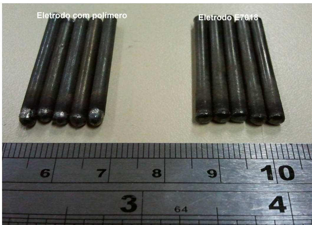
Figura 4.16: Gotas formadas na ponta dos eletrodos obtidas através da interrupção abrupta da soldagem a 30s do início.
