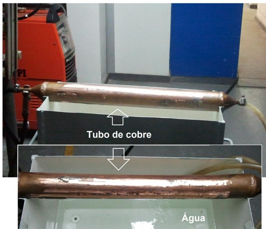
Figura 3.7: Dispositivo empregado na coleta das gotas transferidas desenvolvido por Bracarense (56).
