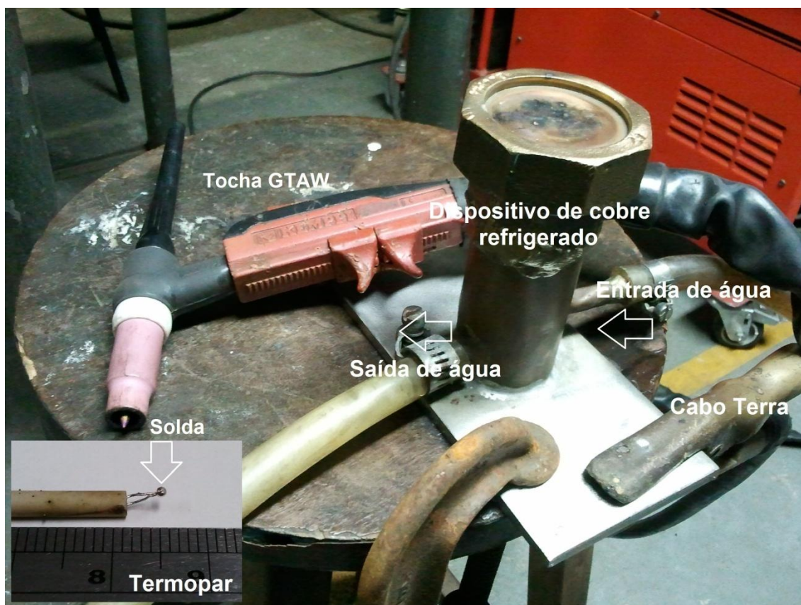
Figura 3.12: Sistema empregado na soldagem dos termopares.
