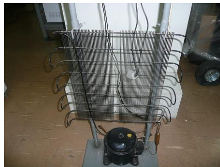
Condensador e compressor
