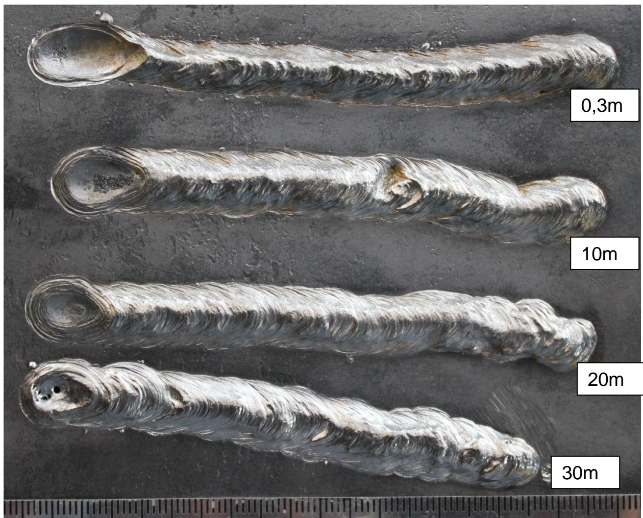
Figura 5. 1: Cordões de solda realizados com o eletrodo E6013, com corrente de soldagem de 170A, em quatro profundidades diferentes (0,3m, 10m, 20m e 30m).
