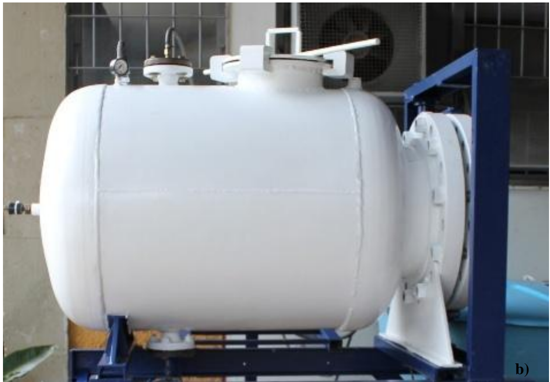
Figura 4. 1: Vaso de pressão antes das alterações construtivas (a) e após ter sido especialmente preparado para soldagem subaquática com escotilha adaptada para remoção de corpos de prova para ensaio de hidrogênio difusível (b).
