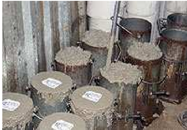
FIGURA 5.14: Moldagem dos corpos de prova.
