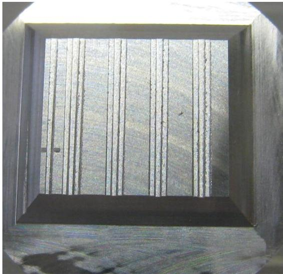
Figura 4.17 – Canais microusinados (16 mm x 16 mm).
