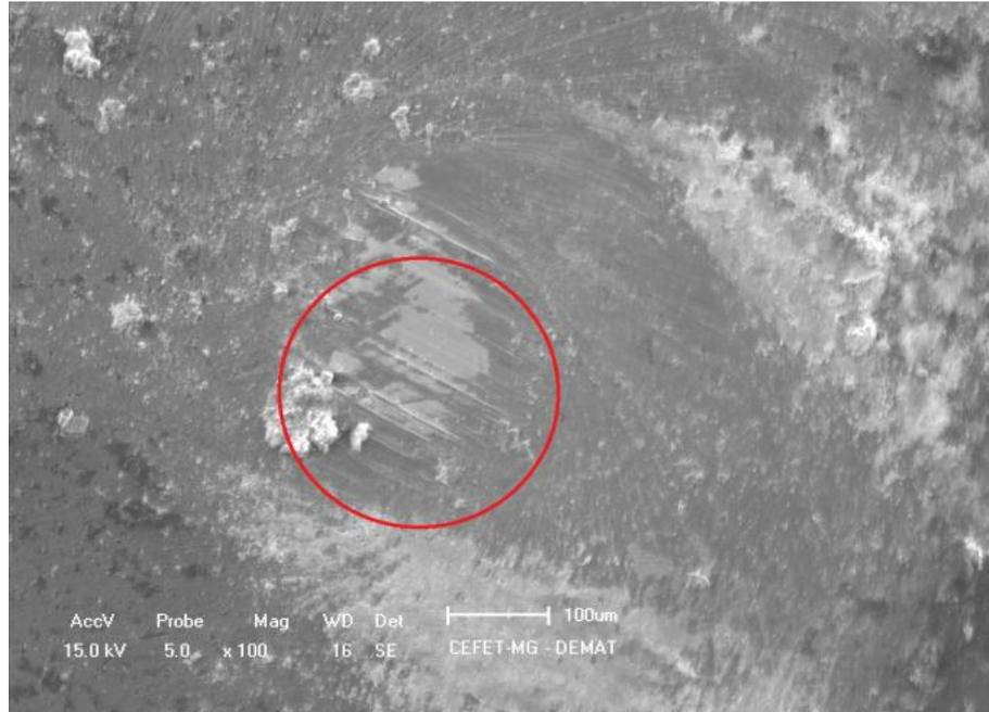
Figura 5.11 – Fotomicrografia do topo esférico do pino de metal duro microgrão revestido com (Ti,Al)N com adesão de níquel puro
