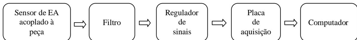
Figura 4.11 – Esquema de montagem para aquisição de sinais de emissão acústica.
