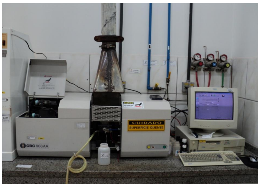
Figura 4.2. Espectrofotômetro de absorção atômica disponível no Laboratório Químico da Votorantim Unidade de Vazante.
