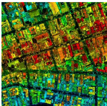
FIGURA 50 - Vista de topo da nuvem de pontos através da representação de cores hipsométricas
