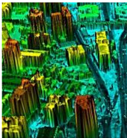
FIGURA 57 – Modelo Digital de superfície – Modelo Digital de Elevação juntamente com as edificações a partir dos dados de laser
