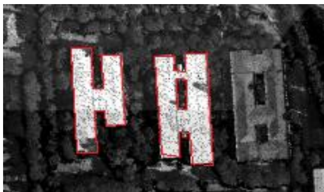
FIGURA 56 - Em vermelho, o vetor gerado automaticamente a partir dos pontos relacionados às edificações.
