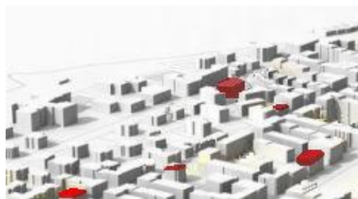
FIGURA 80 – Na figura A, as edificações em cinza são as existentes e as em amarelo representam os estoques construtivos. Na figura B, as edificações existentes estão em cinza e em vermelho os déficits volumétricos.
