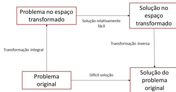
Figura 3.5 - Estrutura de cálculo e solução envolvendo transformadas integrais (Arfken e Weber, 2006).
