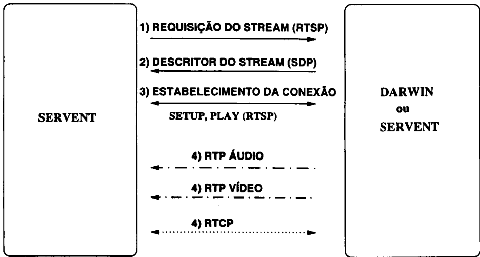
Figura 5.1: Conexão do servent
