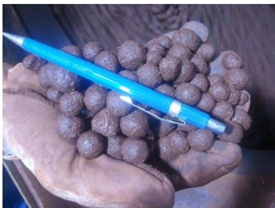
Figura 5.9: Aspecto visual das pelotas cruas com 20 minutos de pelotamento com aglomerante orgânico e CaO do pellet feed em 0,08%.
