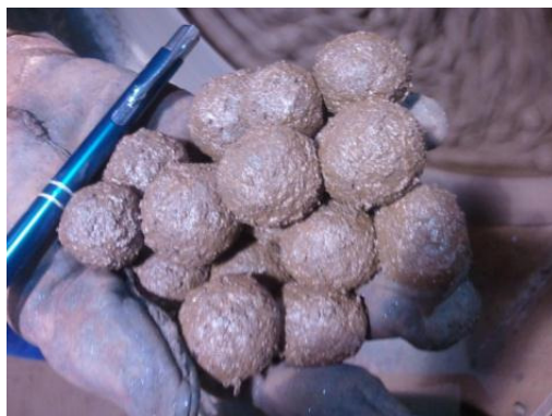
Figura 5.22: Aspecto visual das pelotas cruas com 15 minutos de pelotamento com bentonita e CaO do pellet feed em 0,20%.
