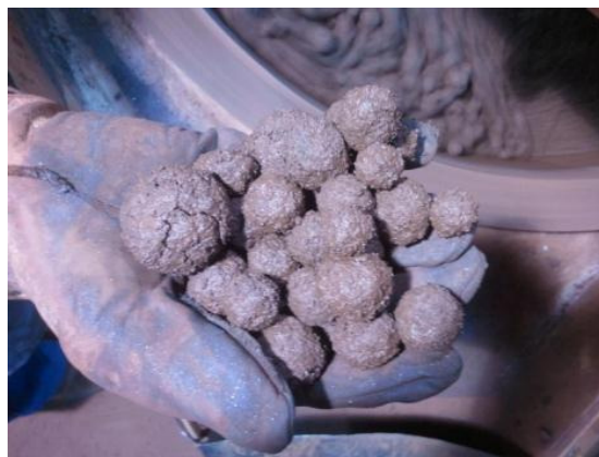
Figura 5.21: Aspecto visual das pelotas cruas com 5 minutos de pelotamento com bentonita e CaO do pellet feed em 0,20%.
