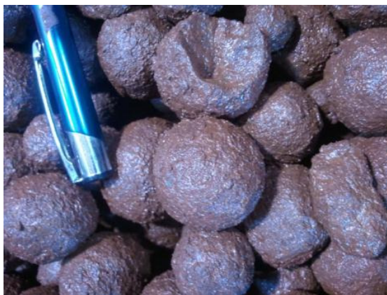
Figura 5.15: Detalhe da elevada umidade superficial das pelotas cruas após o pelletamento com aglomerante orgânico e CaO do pellet feed em 0,20%.
