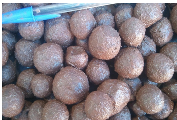
Figura 5.42: Detalhe da elevada umidade superficial das pelotas cruas após o pelotamento com cal hidratada e CaO do pellet feed em 0,26%.
