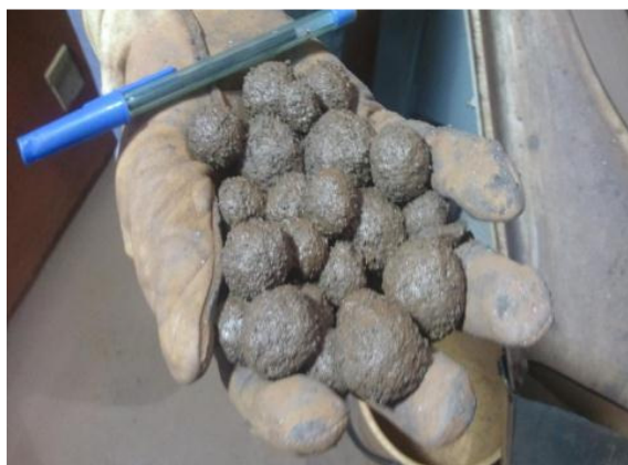
Figura 5.7: Aspecto visual das pelotas cruas com 5 minutos de pelotamento com aglomerante orgânico e CaO do pellet feed em 0,08%.
