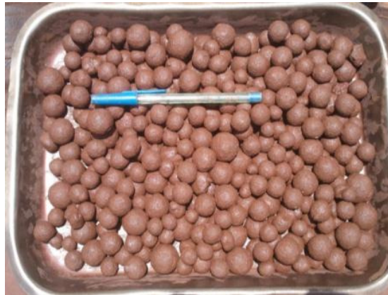
Figura 5.20: Aspecto visual das pelotas cruas após o pelotamento com bentonita e CaO do pellet feed em 0,08%.
