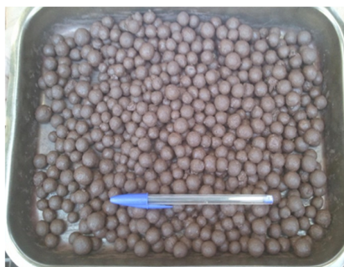
Figura 5.52: Aspecto visual das pelotas cruas após o pelotamento com aglomerante orgânico e CaO do pellet feed em 0,14%.
