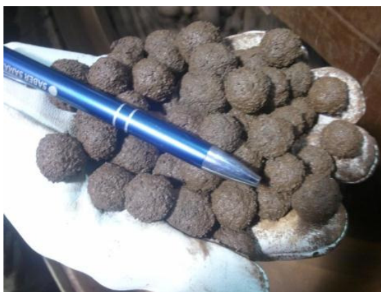
Figura 5.17: Aspecto visual das pelotas cruas com 5 minutos de pelotamento com bentonita e CaO do pellet feed em 0,08%.
