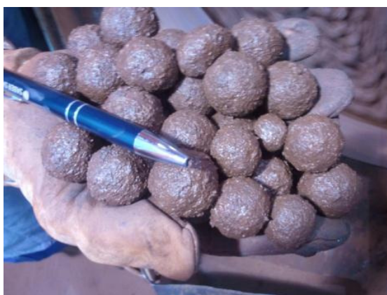
Figura 5.12: Aspecto visual das pelotas cruas com 15 minutos de pelotamento com aglomerante orgânico e CaO do pellet feed em 0,20%.
