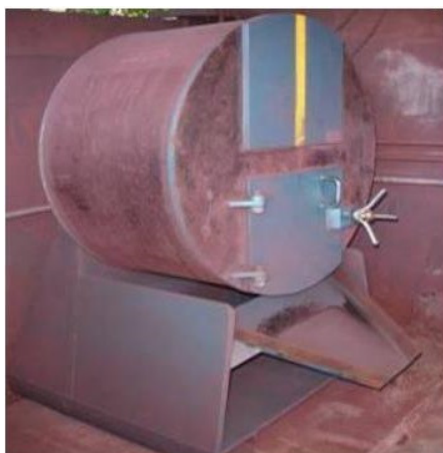
Figura 4.18: Tambor rotativo para teste de tamboramento.
