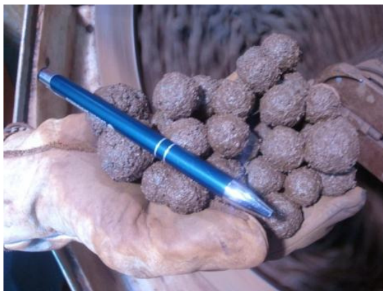
Figura 5.11: Aspecto visual das pelotas cruas com 7 minutos de pelotamento com aglomerante orgânico e CaO do pellet feed em 0,20%.
