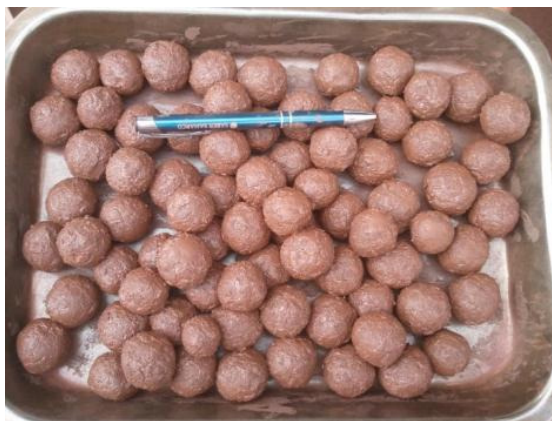
Figura 5.24: Aspecto visual das pelotas cruas após o pelotamento com bentonita e CaO do pellet feed em 0,20%.
