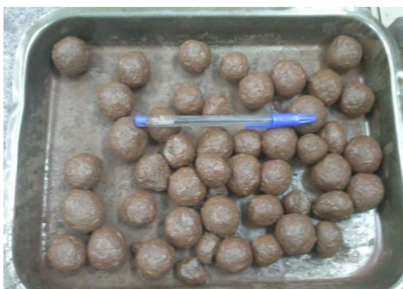
Figura 5.14: Aspecto visual das pelotas cruas após o pelotamento com aglomerante orgânico e CaO do pellet feed em 0,20%.
