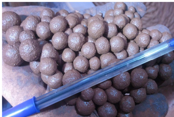
Figura 5.49: Aspecto visual das pelotas cruas com 15 minutos de pelotamento com aglomerante orgânico e CaO do pellet feed em 0,14%.
