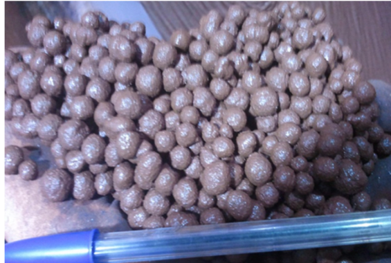
Figura 5.50: Aspecto visual das pelotas cruas com 20 minutos de pelotamento com aglomerante orgânico e CaO do pellet feed em 0,14%.
