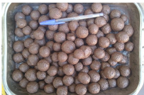
Figura 5.41: Aspecto visual das pelotas cruas no disco de pelotamento após término do teste com cal hidratada e CaO do pellet feed em 0,26%.
