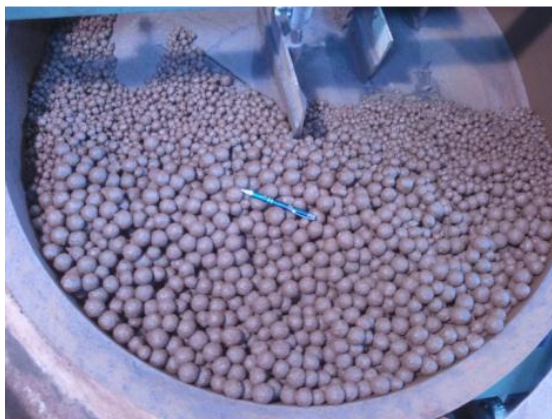
Figura 5.13: Aspecto visual das pelotas cruas no disco de pelotamento após término do teste com aglomerante orgânico e CaO do pellet feed em 0,20%.
