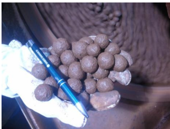
Figura 5.18: Aspecto visual das pelotas cruas com 10 minutos de pelotamento com bentonita e CaO do pellet feed em 0,08%.
