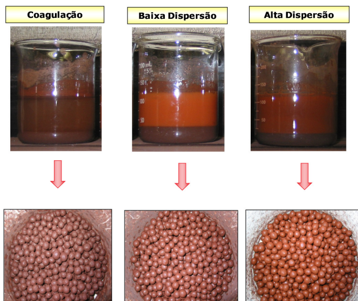
Figura 1.1: Influência do grau de dispersão do pellet feed na formação das pelotas cruas: pelotas secas e com baixa resistência mecânica (1º cenário); pelotas com elevada umidade superficial (3º cenário); situação intermediária desejada (2º cenário) (DOELLINGER, 2011).
