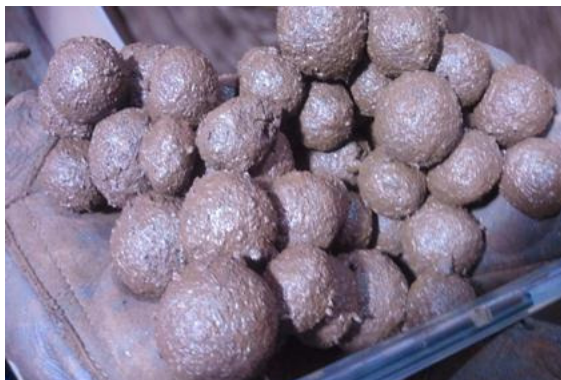
Figura 5.37: Aspecto visual das pelotas cruas com 10 minutos de pelotamento com cal hidratada e CaO do pellet feed em 0,26%.
