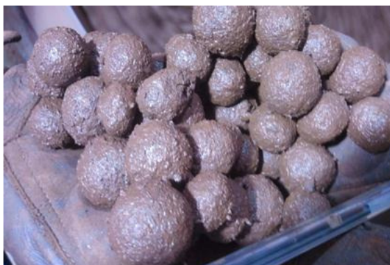
Figura 5.38: Aspecto visual das pelotas cruas com 15 minutos de pelotamento com cal hidratada e CaO do pellet feed em 0,26%.
