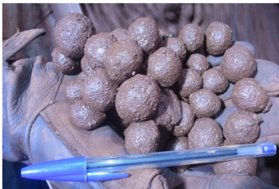
Figura 5.39: Aspecto visual das pelotas cruas com 20 minutos de pelotamento com cal hidratada e CaO do pellet feed em 0,26%.
