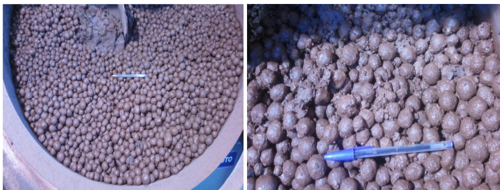
Figura 5.40: Aspecto visual das pelotas cruas no disco de pelotamento após término do teste com cal hidratada e CaO do pellet feed em 0,26%.
