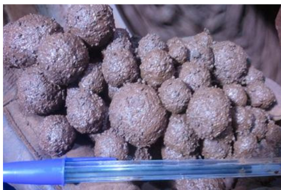
Figura 5.36: Aspecto visual das pelotas cruas com 5 minutos de pelotamento com cal hidratada e CaO do pellet feed em 0,26%.
