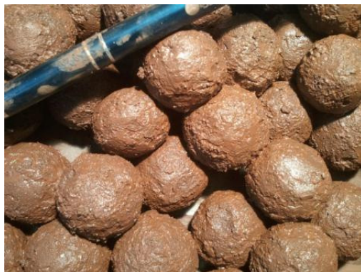
Figura 5.25: Detalhe da elevada umidade superficial das pelotas cruas após o pelotamento com bentonita e CaO do pellet feed em 0,20%.
