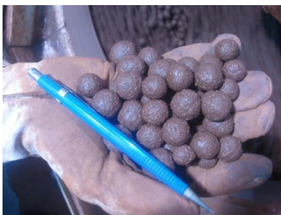
Figura 5.8: Aspecto visual das pelotas cruas com 10 minutos de pelotamento com aglomerante orgânico e CaO do pellet feed em 0,08%.
