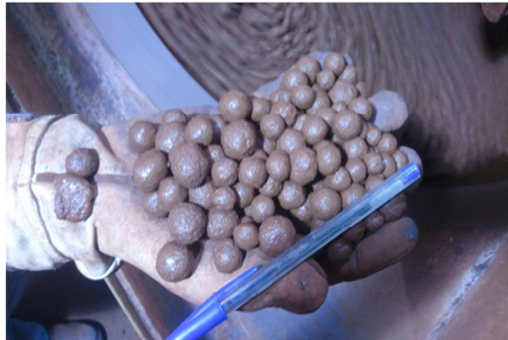
Figura 5.48: Aspecto visual das pelotas cruas com 10 minutos de pelotamento com aglomerante orgânico e CaO do pellet feed em 0,14%.
