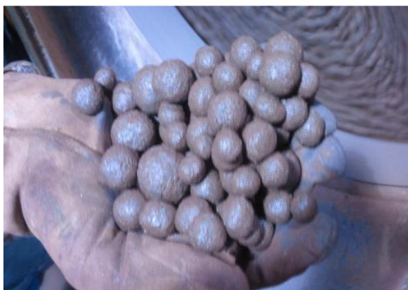
Figura 5.19: Aspecto visual das pelotas cruas com 20 minutos de pelotamento com bentonita e CaO do pellet feed em 0,08%.
