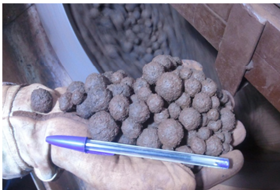
Figura 5.47: Aspecto visual das pelotas cruas com 5 minutos de pelotamento com aglomerante orgânico e CaO do pellet feed em 0,14%.
