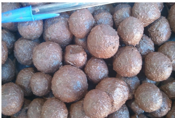
Figura 5.53: Detalhe da elevada umidade superficial das pelotas cruas após o pelotamento com aglomerante orgânico e CaO do pellet feed em 0,14%.
