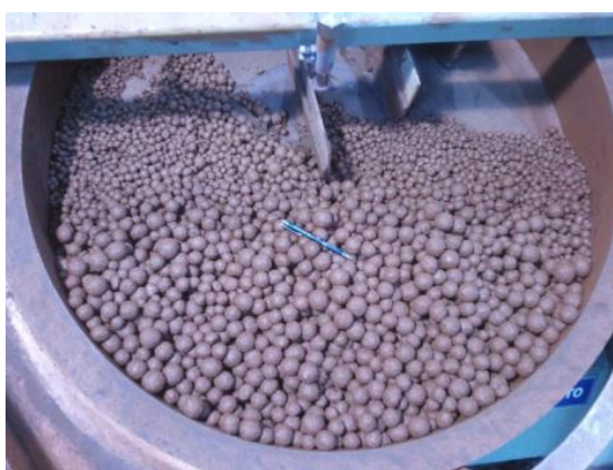
Figura 5.23: Aspecto visual das pelotas cruas no disco de pelotamento após término do teste com bentonita e CaO do pellet feed em 0,20%.
