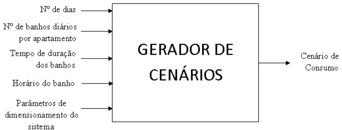
FIGURA 3.5 - Princípio de funcionamento do Gerador de Cenários (elaborada pelo autor)
