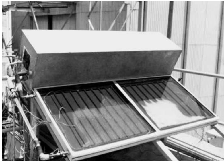
FIGURA 2.5 - Sistema SDHW utilizado para o teste.
