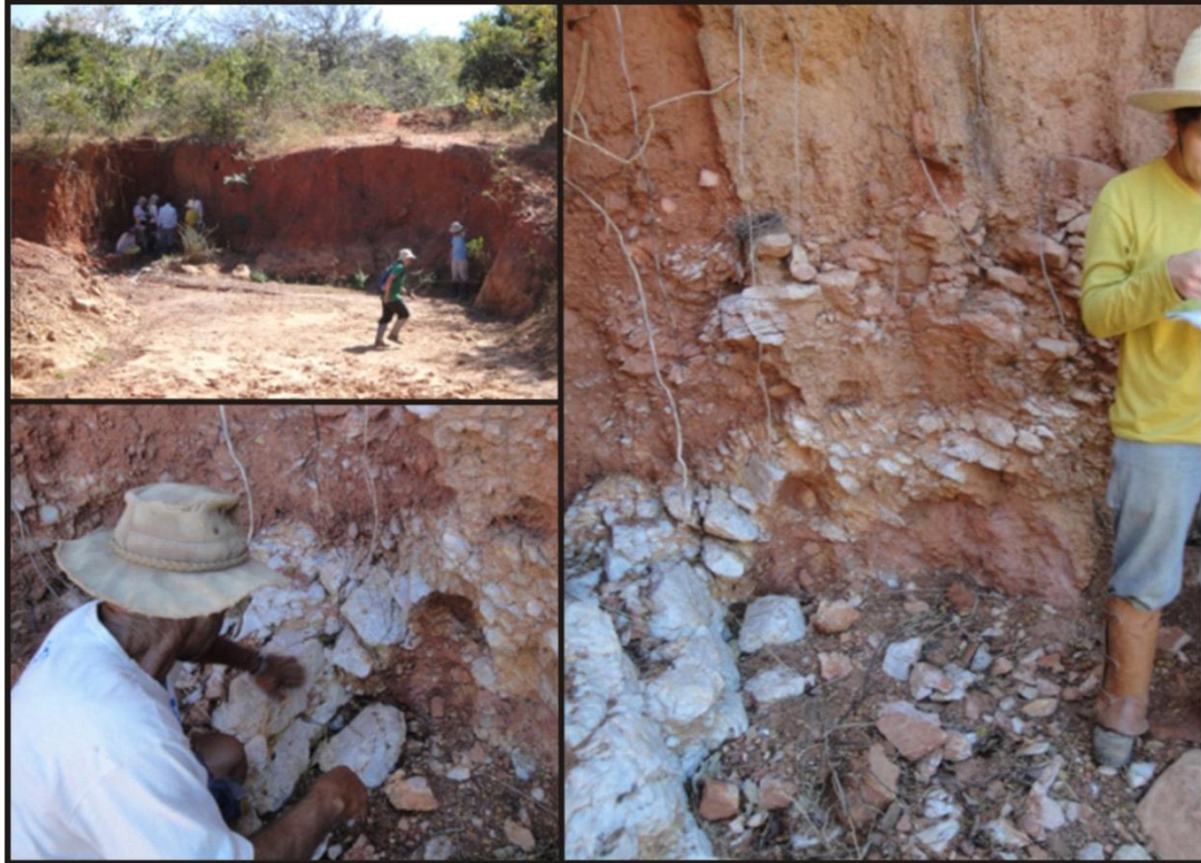
Foto 2 – Jazida de quartzo das Bibocas (em atividade). Os garimpeiros realizaram um corte no barranco para seguir o filão hidrotermal. Formam-se pilhas de rejeito com sedimento e quartzo sem valor agregado. Esta atividade é denominada localmente de garimpo de “custelão” em referência ao quartzo amorfo com cristais entremeados. (Fotos: Luiza Câmpera)
