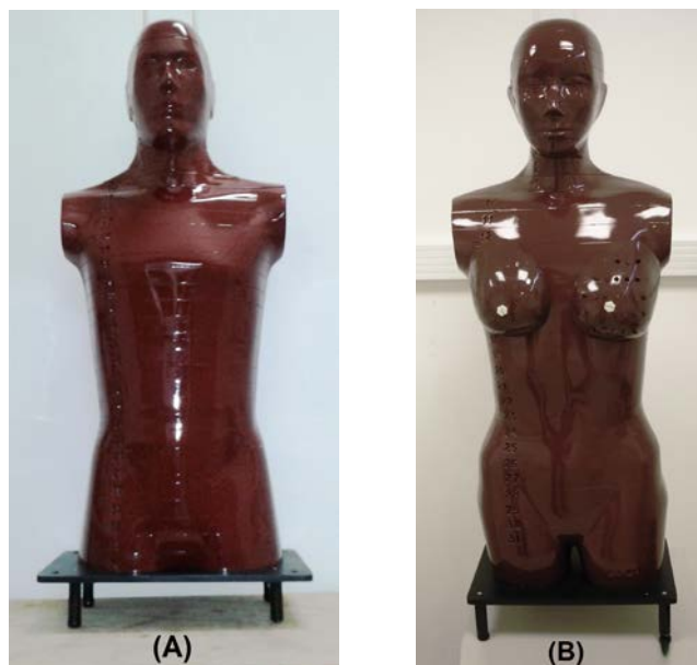
Figura 9. Simulador antropomórfico Alderson Rando ® (A) masculino e (B) feminino.
