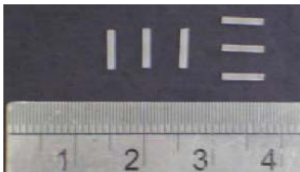
Figura 10. Detectores bastão LiF: Mg, Ti utilizados para determinação da dose efetiva e absorvida.
