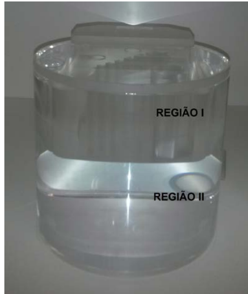
Figura 14. Simulados VCT QA para estudo da qualidade das imagens em CT, a região I constituída de acrílico e a região II de água deionizada.
