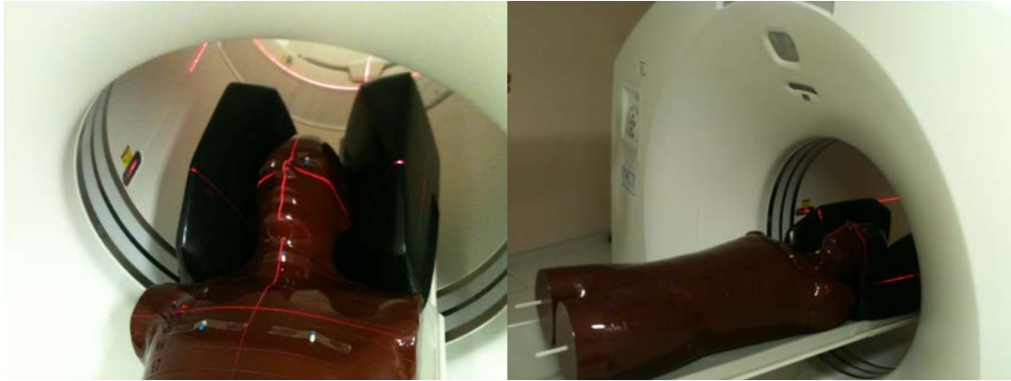
Figura 13. Simulador antropomórfico Alderson Rando® masculino posicionado para irradiação proveniente da tomografia computadorizada do PET-CT.
