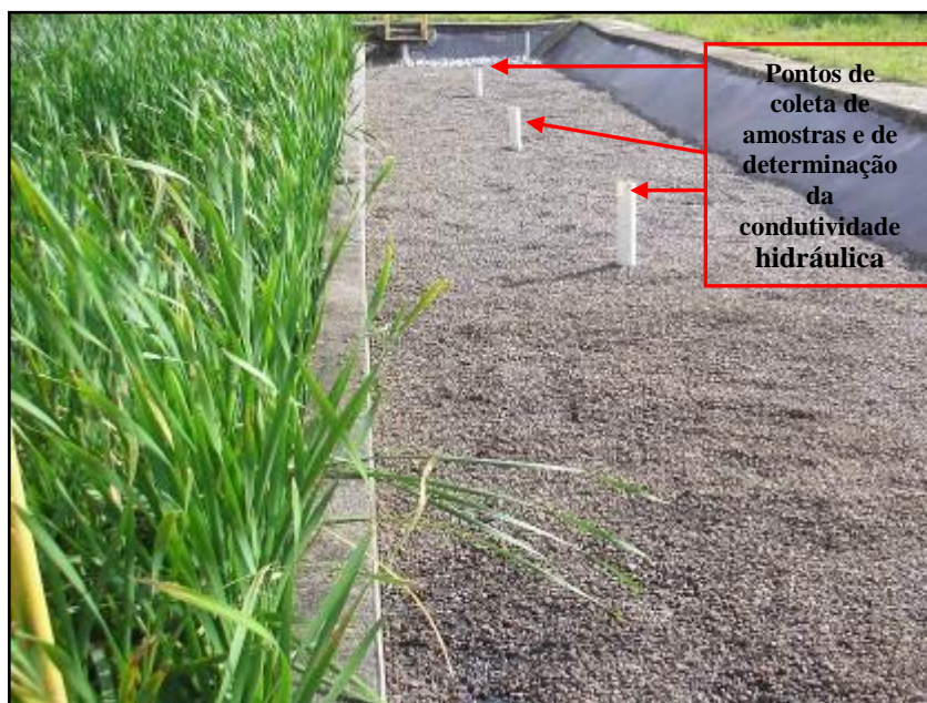
Figura 4.11 - Pontos de coleta de amostras e de determinação da condutividade hidráulica nas unidades do SACs
