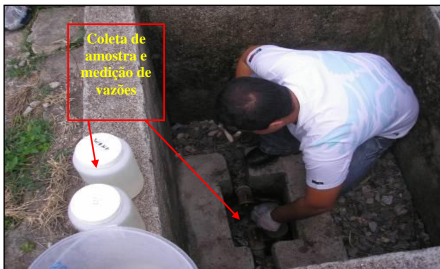
Figura 4.14 - Coleta de amostras e medição de vazões na saída das unidades do SAC
