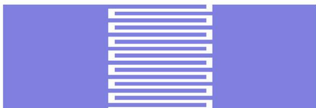
Figura 2.12 – Imagem da máscara que foi aplicada durante o processo de litografia para construção dos dispositivos com TNTs.
