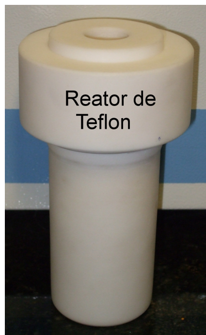
Figura 2.5 – Reator de teflon utilizado no processo de síntese dos TNTs por refluxo. Possui tampa rosqueável e seu interior tem capacidade de até 300 mL de solução.
