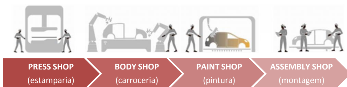
Figura 3.1. Esquema das etapas de um processo típico de fabricação de automóveis.
