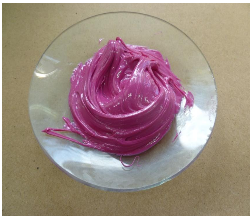
Figura 4.1. Adesivo estrutural monocomponente de base química epoxídica.
