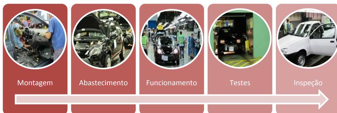
Figura 3.5. Esquema das principais etapas de um processo típico de assembly shop .
