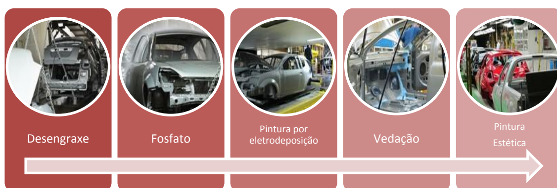
Figura 3.4. Esquema das principais etapas de um processo típico de paint shop .
