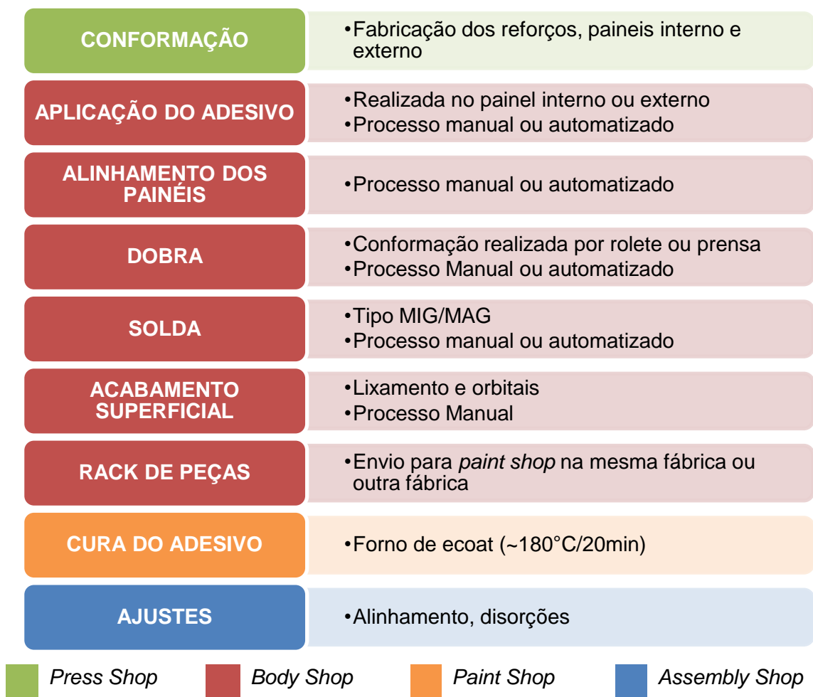
Figura 5.57. Esquema e detalhes de um processo típico de fabricação de partes móveis de veículos.
