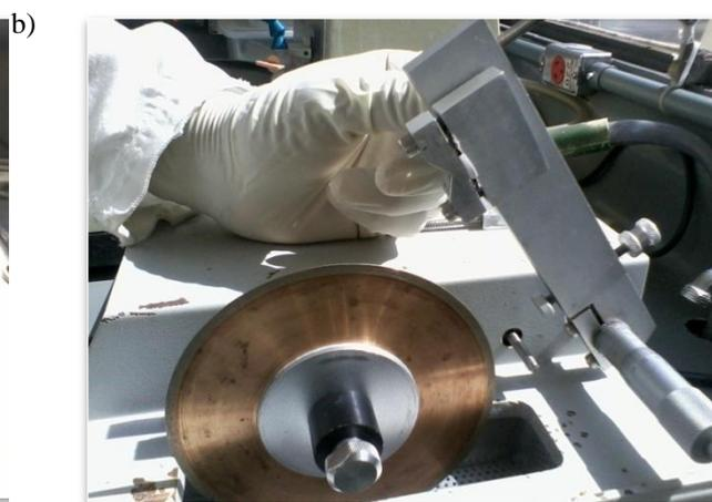
Figura 20 – Isomet utilizada para corte das pastilhas de  $\alpha\text{-Al}_2\text{O}_3\text{:C}$  (a). Em (b), preparação do corte das pastilhas.
