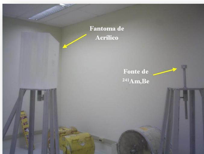
Figura 24 - Setup para irradiação com nêutron rápidos em uma fonte de  $^{241}\text{Am-Be}$ . Os dosímetros são colocados em um fantoma de acrílico em uma distância de 75 cm da fonte. (Laboratório de dosimetria de nêutrons do CRCN-NE)
