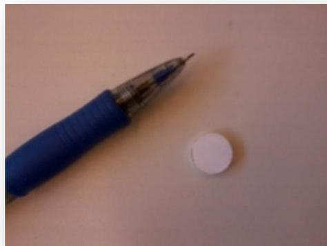
Figura 18 – Amostra cilíndrica de  $\alpha\text{-Al}_2\text{O}_3\text{:C}$  prensada com 6 toneladas.
