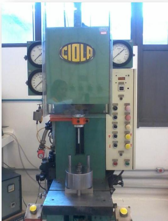
Figura 17 – Prensa utilizada na produção de pastilhas de  $\alpha\text{-Al}_2\text{O}_3$  nano e microparticuladas.
