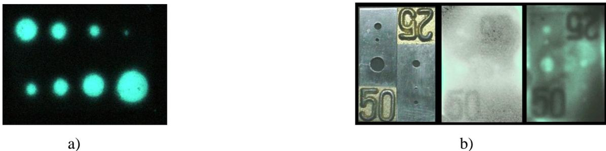
Figura 11 - Imagem radiográfica produzida por um Filme Termoluminescente de P(VDF-TrFE)-PMMA/ CaSO<sub>4</sub>:Mn reproduzindo a) uma chapa de Chumbo com furos de diâmetros de 1mm até 4 mm e b) um padrão radiográfico (fotografia à esquerda) coberto por uma chapa de aço de 1,64 mm (centro) e 0,5 mm (direita). Os furos do padrão radiográfico possuem diâmetros de 0,2, 0,02 e 0,1 mm (número 50) e de 0,1, 0,01 e 0,025 mm (número 25) [33].
