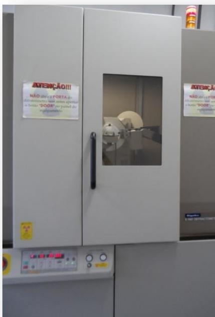
Figura 28 – Microscópio: marca Rigaku, modelo D/MAX Ultima Automático, com goniômetro  $\theta$ - $\theta$  e tubo de raios X de cobre do CDTN.
