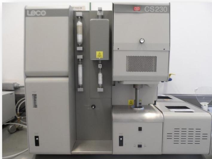
Figura 29 – Analisador de carbono e enxofre LECO – modelo CS-230.
