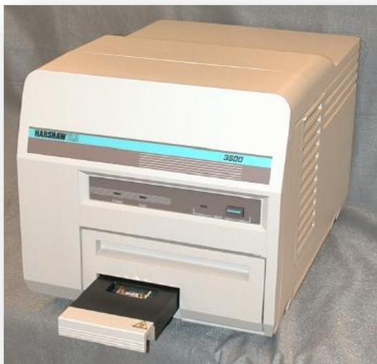
Figura 26 - Leitora termoluminescente Harshaw 3500.
