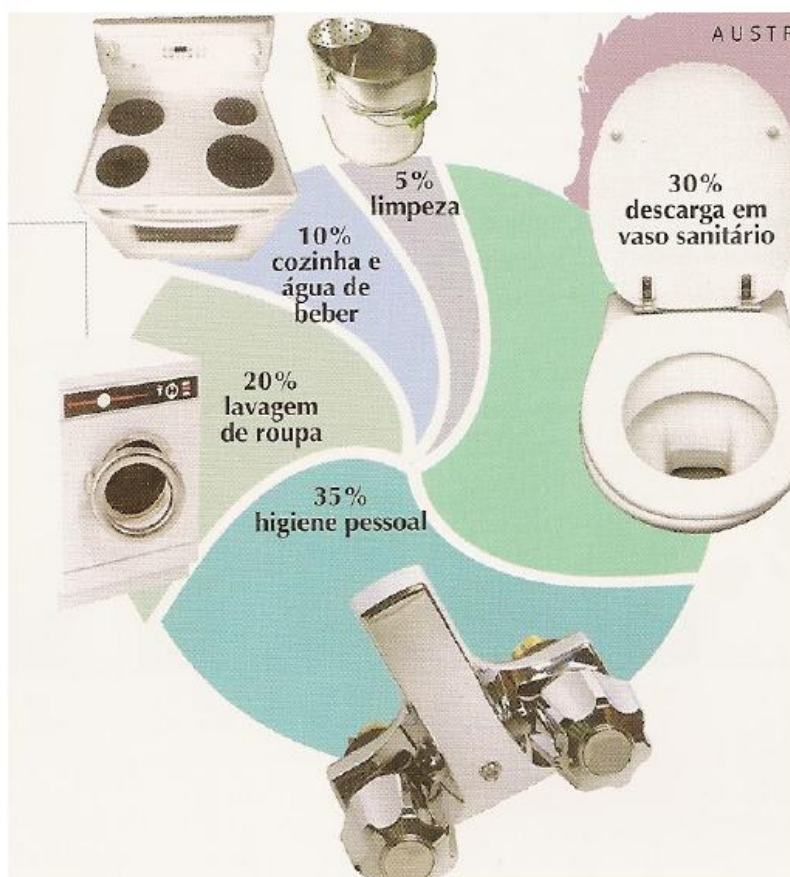
Figura 3.14 – Estimativa aproximada das quantidades de água por usos domésticos. Fonte: Clark e King, 2005 apud COLLISCHONN & TASSI, 2011
