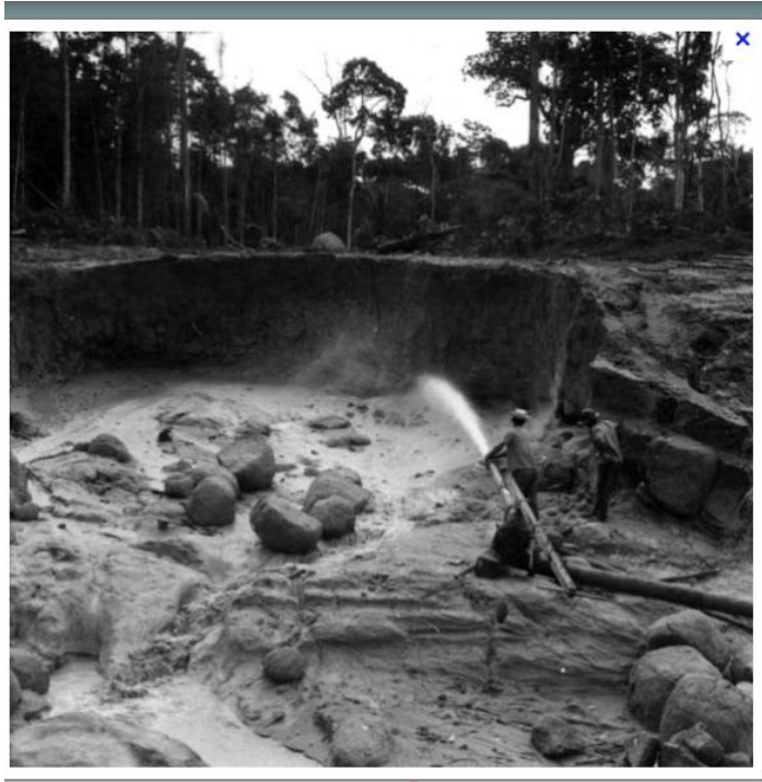
Figura 3.6 – Lavra por desmonte hidráulico
