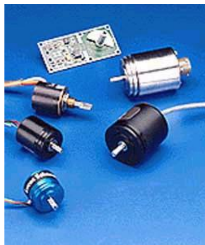
FIGURA A5.5 – (a) Vista transparente de um “encoder” e (b) Montagens e encapsulamentos destes.
