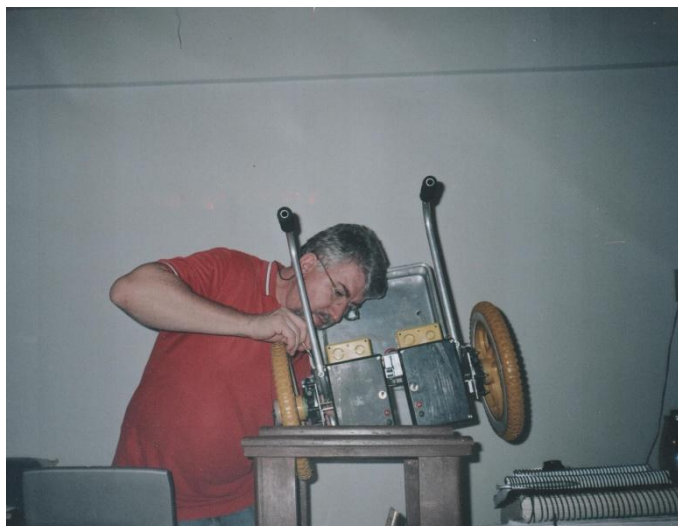
FIGURA A5.31 - Montagem da cadeira de rodas robótica e equilibrista
