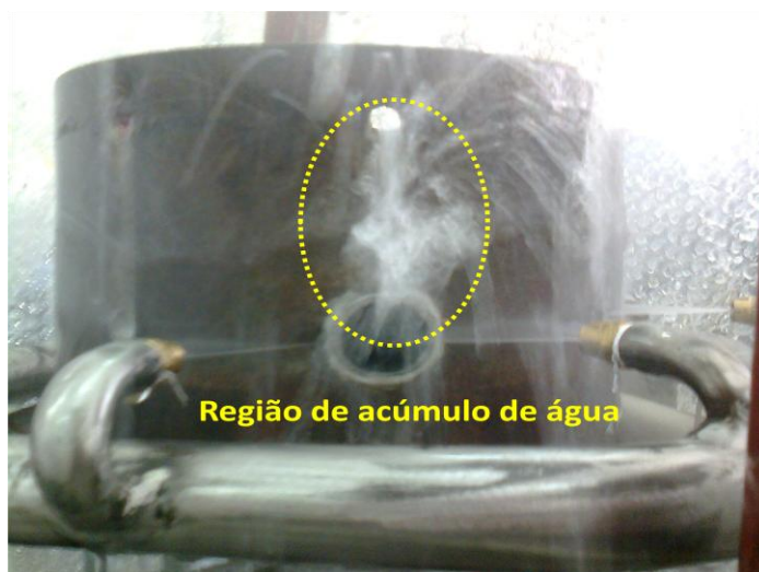
Figura 5.6 – Acúmulo de água na superfície do tubo de teste devido à projeção de dois bicos spray adjacentes
