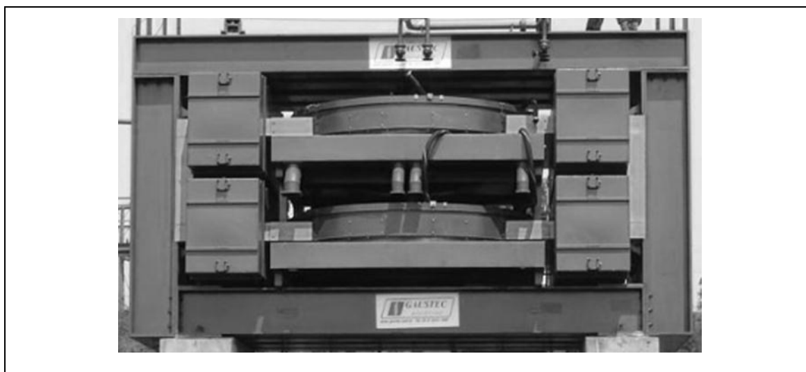
Figura 3.9 - Separador eletromagnético de carrossel G-3600 (Fonte: site GAUSTEC)
