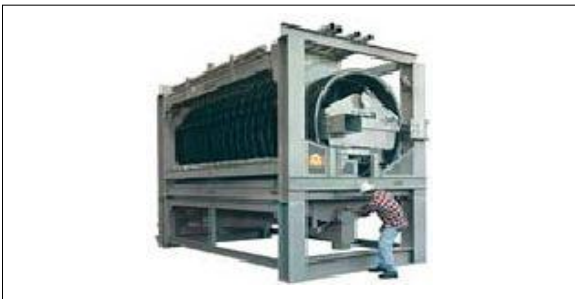
Figura 3.8 - Separador magnético Ferrous Wheel (Fonte: site INBRÁS-ERIEZ)
