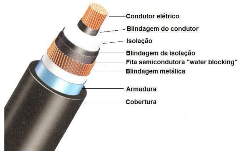
Figura 3.2 - Constituição de um cabo elétrico isolado [2].
