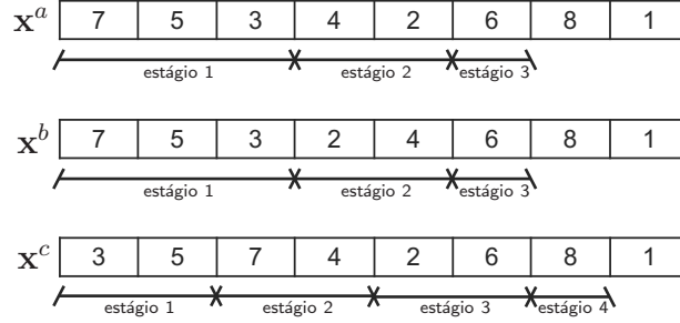
Figura 4.7 \mathbf{x}^a e \mathbf{x}^b , apesarem de serem indivíduos diferentes, compartilham o mesmo fenótipo, pois definem a mesma sequência de scheduling . \mathbf{x}^a e \mathbf{x}^c não compartilham o mesmo fenótipo, pois definem diferentes sequências de scheduling dos nós sensores.
