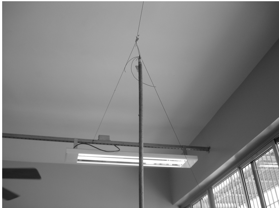
Figura 4.51: Fio de nylon erguendo o canal espiral e terminação aberta
