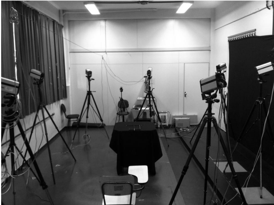
FIGURA 2: Posicionamento das câmeras do sistema tridimensional de análise de movimento (Qualisys Pro-Reflex ® ) ao redor da área de coleta.
