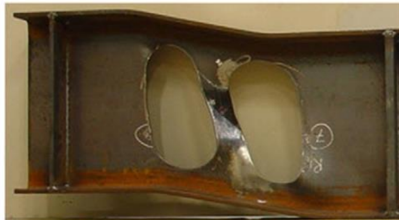
Figura 1.17 – Mecanismo Vierendeel (Tsavdaridis e D’Mello, 2010).
