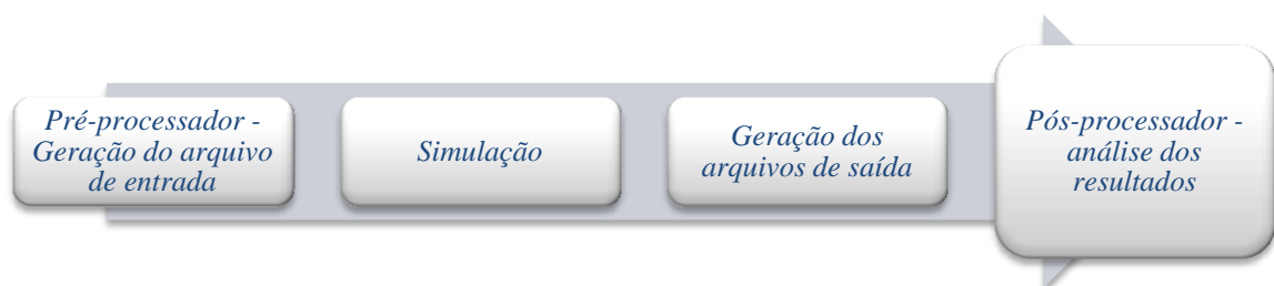
Figura 3.1 – Procedimento simplificado de resolução de um problema via MEF.
