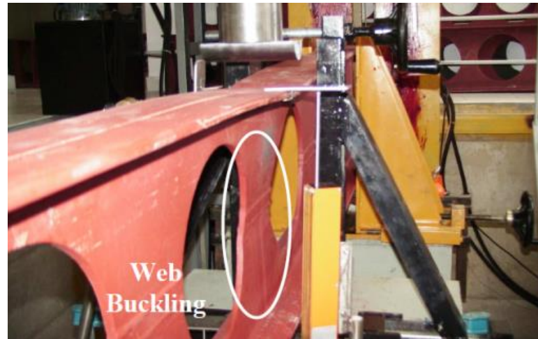
Figura 1.16 – Flambagem do montante de alma devida à compressão (Erdal, 2011).
