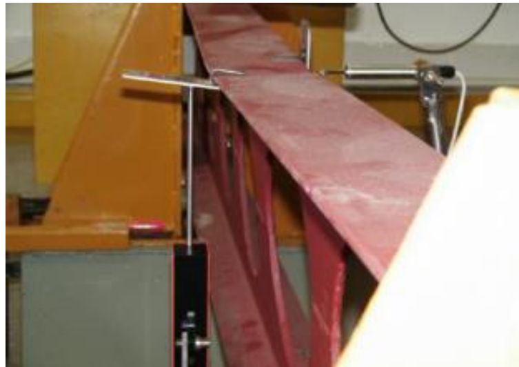
Figura 1.19 – Flambagem lateral com torção (Erdal, 2011).
