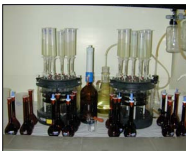
Figura 9: Esquema utilizado para os procedimentos de purificação do extrato e lavagem da coluna de imunoafinidade.
