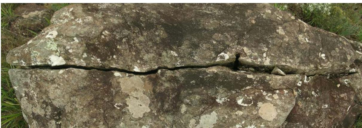
FIGURA 188 - Corte em bloco feito através de piques e fendas.
