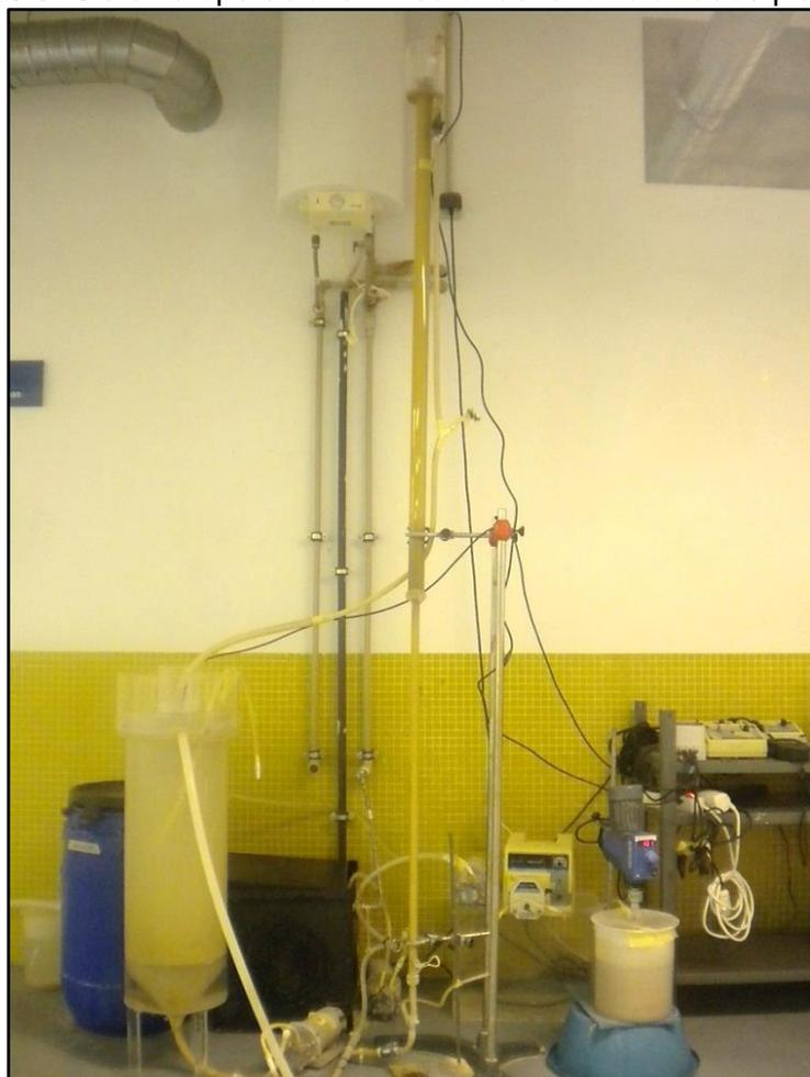
Com aproximadamente 30 dias de operação, obteve-se os resultados apresentados na Figura 5.5.9, que demonstram o monitoramento do pH, além das concentrações de  $P-PO_4^{3-}$  na alimentação e no efluente, o que possibilitam uma avaliação da remoção de nutrientes através do processo de precipitação da estruvita.
