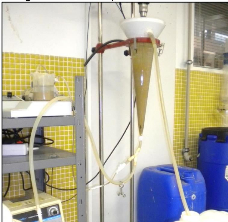
Com aproximadamente 20 dias de operação, obteve-se os resultados apresentados na Figura 5.5.4, que demonstra o monitoramento do pH, além das concentrações de P-PO<sub>4</sub><sup>3-</sup> na alimentação e no efluente, o que possibilita uma avaliação da remoção de nutrientes através do processo de precipitação da estruvita.
