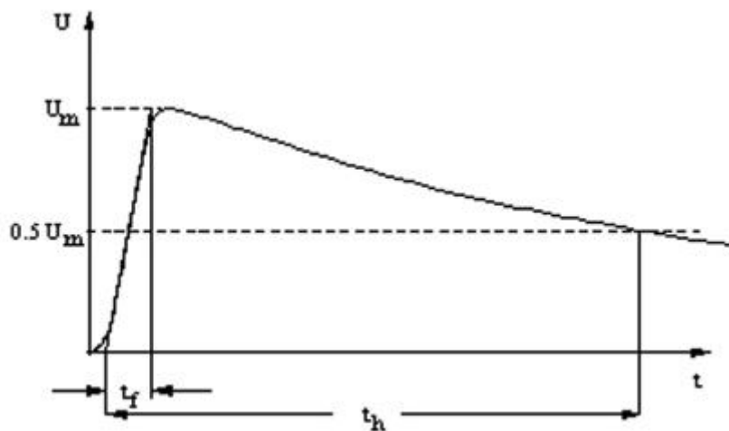
Figura 2.2. Exemplo de onda de corrente obtida pela aplicação da Função de Heidler. [King, 2004]
