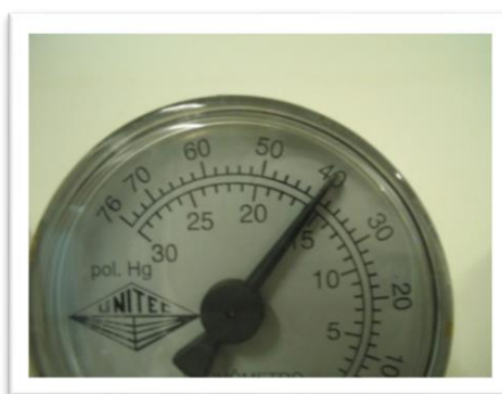
FIGURA 3 - Vacuômetro demonstrando a pressão de aspiração em 400 mmHg.
