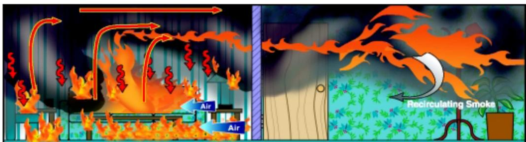
Figura 2.4 - Gases quentes fluem para o compartimento adjacente
