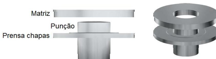
Figura 4.11 – Representação esquemática do ferramental a ser utilizado para a estampagem dos corpos de prova do ensaio de indentação.
