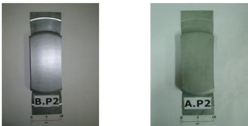
Figura 4.12 – Aspectos dos corpos de prova dos aços BH260 e IFHSS260, estampados em escala laboratorial para avaliação do ganho de resistência mecânica por deformação, envelhecimento e da resistência à indentação.
