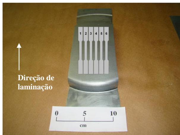
Figura 4.13 – Locais onde os corpos de prova sub-size da norma ASTM A370 foram retirados das amostras do ensaio de avaliação do ganho de resistência propiciado pelos efeitos WH e BH.
