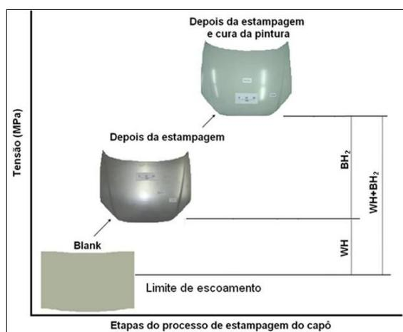
Figura 1.6 – Ilustração esquemática do aumento do limite de escoamento de um capô automotivo após conformação (WH) e após tratamento térmico de cura da pintura – BH<sub>2</sub><sup>(4)</sup>.
