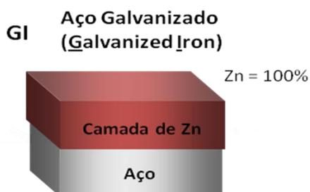
Figura 4.6 – Desenho esquemático do Revestimento no material.
